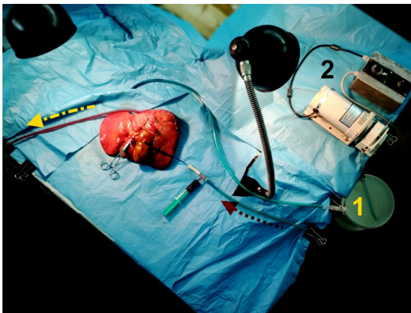
Рис. 1. Установленный перфузионный контур. 1 – резервуар с перфузионным раствором, 2 – роликовый насос с регулятором скорости, красная стрелка с пунктиром – система притока перфузата, желтая стрелка с штрих-пунктиром – система оттока перфузата.
